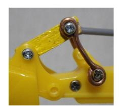
写真のように組み立てて、ビスを通して止めました。ナットの部分は接着剤を付け、抜け止めしました。
