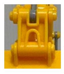
リンクの内、バケットにつながるパーツはこんな形をしています。 アルファベットの「H」に似たその形から、「Hリンク」と呼ばれ ています。上部はピンで油圧ピストンにつながります。
