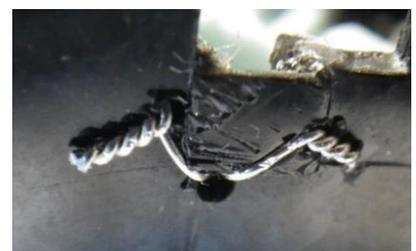
ルーターで壁面を荒らした所に、ワッシャーを接着しました。補強のために、0.28mmのステンレス線で結束しました。ギヤボックスの外側から見るとこんな感じです。
