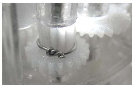
ギヤボックスを分解した結果、ピニオンギヤが2個割れていることが分かりました。1個は、スペース的に補修が難しく、同規格の代替品があるので、新品に交換しました。
