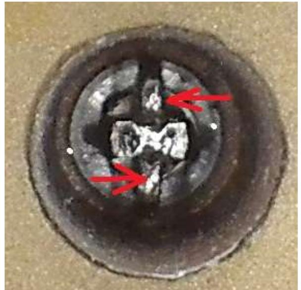
矢印の方向に押して、先端がネジになったシャフトを抜きます。
