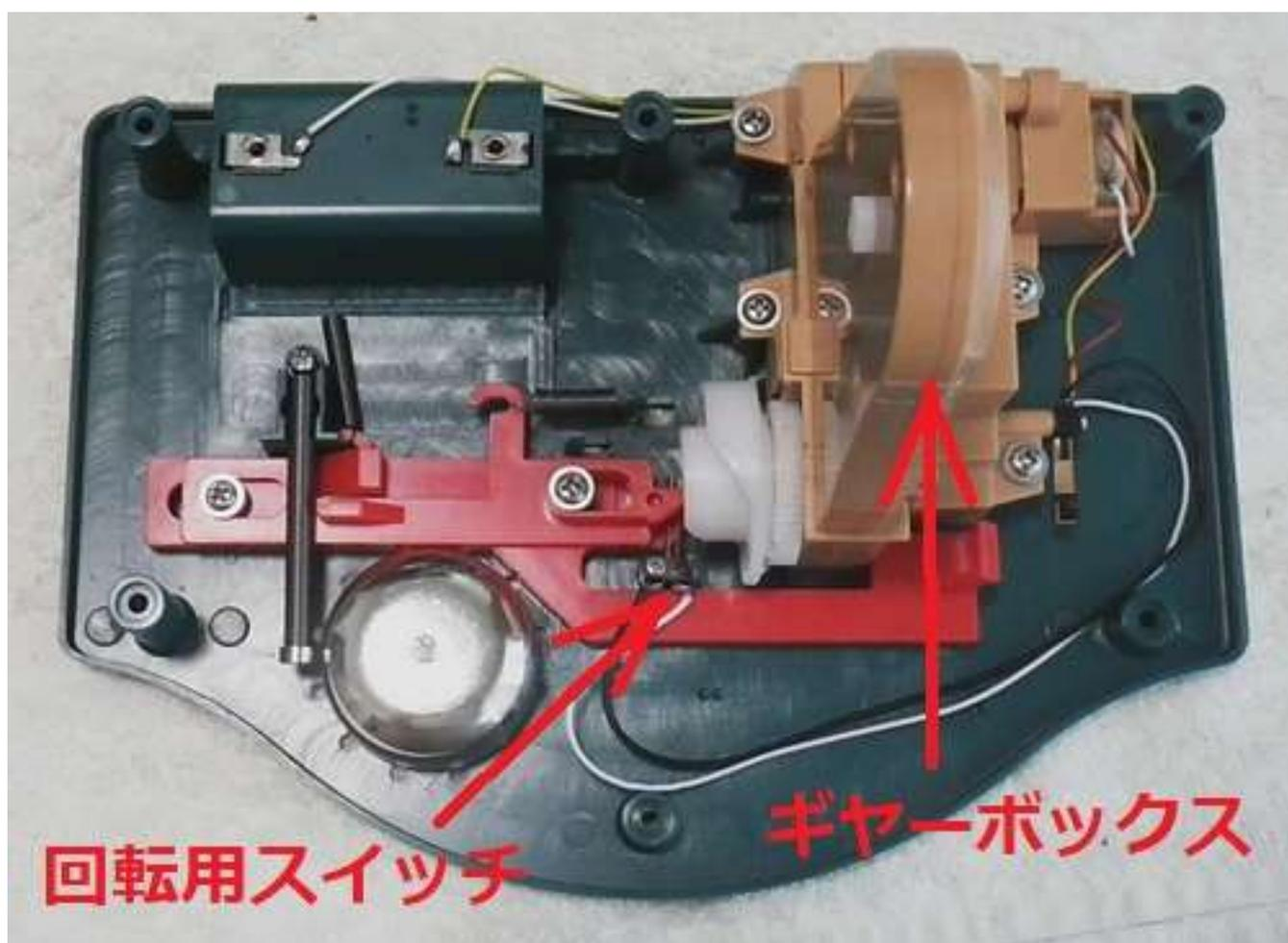
回転用スイッチはスイッチオン後、1 週回するためのスイッチでカムを利用しています。カムを利用した自動化です。
