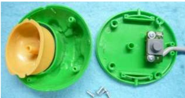
分解し、新しいコード被覆を剥がし、2本の芯線を直接プリント基板に半田付けし、コードを引き回します。
