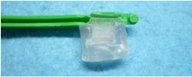
・欠けた部分に型材を取付け、**造形修復材を流し込み**ました。
