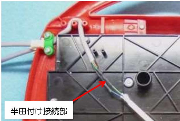
プリント基板とコード引き出し口までの間で、古いコードを切断し、新しいコードの被覆を剥がし、引き回しの途中で芯線を半田付けし、絶縁のため収縮チューブを被せます。
