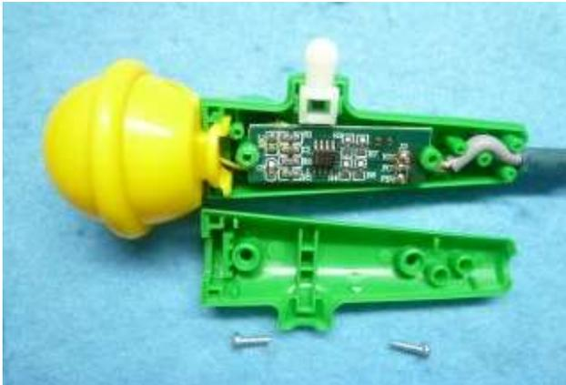
コード被覆を剥がし、3本の芯線を直接プリント基板に半田付けし、コードを引き回します。
