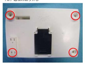
〇印のネジ(タッピング3×8)4本を外します。
