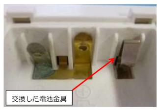
コントローラの電池金具の錆の程度が酷く、研磨の際に1か所の端子が折れてしましました。
