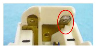
修理方法は、ルーターでコントローラと電車本体 の錆びた電池金具を、研磨しました。
