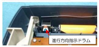
進行方向指示ドラムを軸受けに取付けます。
