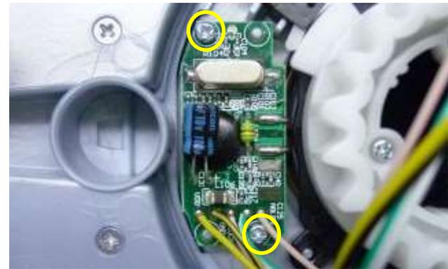
○印のネジ（タッピング2×5）2本を外します。
