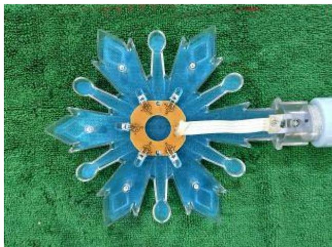
柄部には制御プリント基板と、下LEDへのリボンケーブルと、先端☆部のLEDへのリード線があります。
