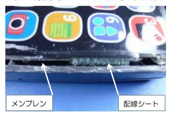
他の注意点として、操作パネルの数字の「6と9」辺りにある内側のメンブレンシートの配線シートと両側面にメンブレンがあることです。側面を切る際に上枠に深く刃を入れすぎて、配線シートやメンブレンを切らないようにします。
