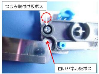
問題は中央よりの左右のボス(赤〇印)です。上に操作パネル、下につまみ取付け板ボスがあります。分かり辛いのでケースの側面部を切り落とし、ボスとボスの間の狭い場所に、三角形のノコギリで上のボスを切り落としました。
