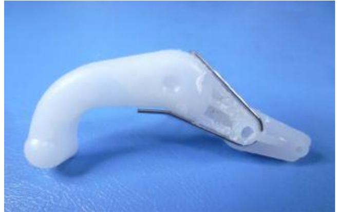
（d）添え線（ $\phi 0.85\text{mm}$ ステンレス線）の縛り
