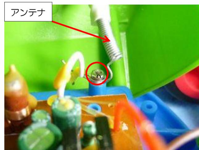
シャーシにある○印のネジ（タッピング 2.6X5）を外すと、アンテナが外れ、ボディーが外れます
