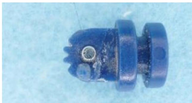
樹脂から飛び出たネジ頭をヤスリで削り、表面にグリスを塗布します。
