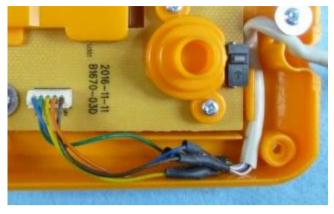
マウスのケーブルはコネクタに端子があるので、 途中で切断し、新しいケーブルの線と半田付けし、 収縮チューブで絶縁します。
