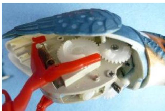
足端子にワニロリード線で電圧を加え、モータのピニオンギアを強制的に回転させると、動き出しました。
