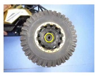
側面から、サスペンションスプリングと連結アーム上、そして連結アーム下を留めている〇印の特殊段付きトラスネジ(高さ 16、ネジ部タッピング3X6)を左右から各1本、計6本を外します。
