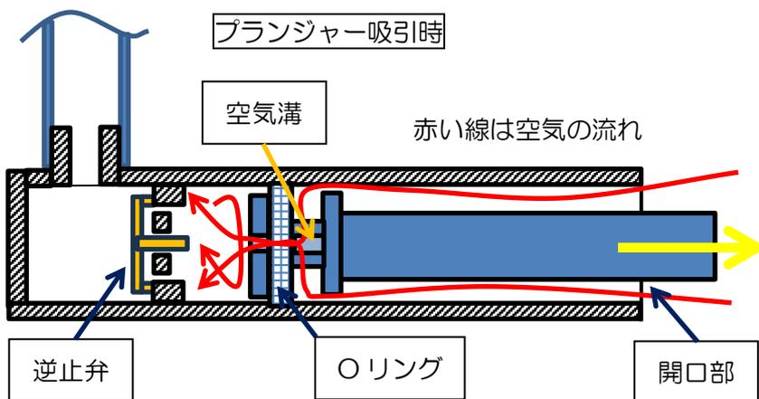
Oリングが先端に移動し。逆止弁が吸引され、シリンダー開口部から空気が入り、空気溝を通して、逆止弁で囲まれた空間に空気が溜まります。
