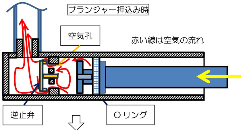
Oリングが手前に移動し。逆止弁が押され、壁の空気孔から溜まっていた空気が押されて先端の空間に入り、パイプを通してタンクに空気が押し込まれます。
