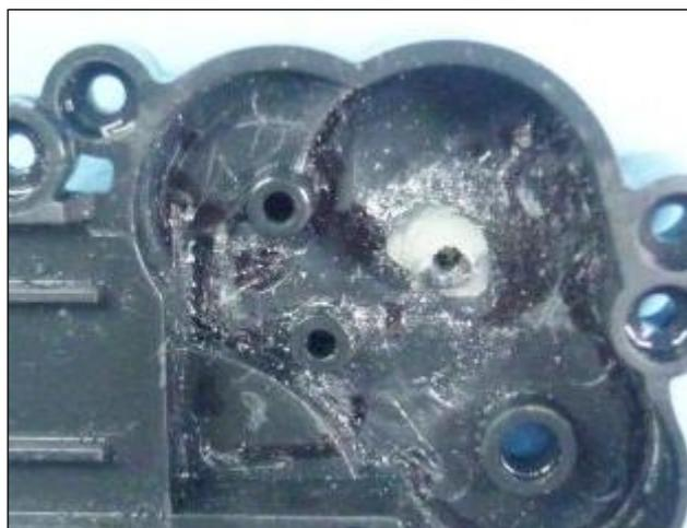
硬化後、飛び出た部分にヤスリ掛けし、軸孔にシリコングリスを入れます。
