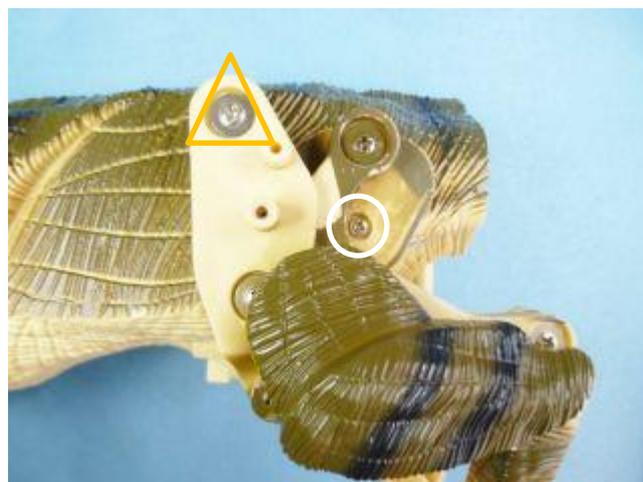
左後脚回転板を細いマイナスドライバーでそ〜っと浮かして外し、その時角軸と角軸受け孔との挿入位置関係を間違わないように、黒マジックで角にマーキングします。
