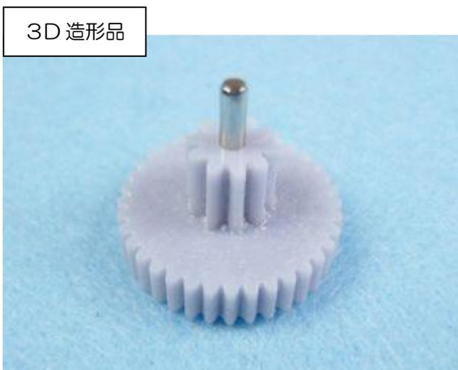
3D 造形した 2 段ギアと交換します。
