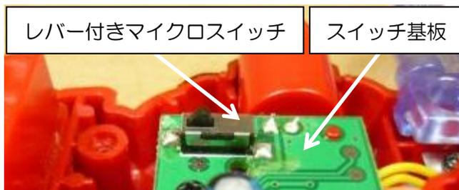
このボタン裏面突起の一瞬の上下によって、ソニックアロー内部にあるスイッチ基板のレバー付きマイクロスイッチも一瞬オン状態になり、ソニックアローの音や光が連動する仕組みです。
