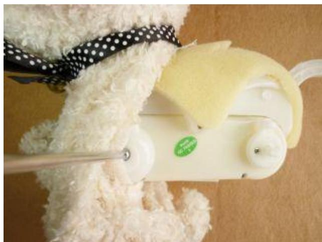
ぬいぐるみの左前脚部に前脚を入れ、左前脚の支点を回転板外側の回転支持ピンを位置合わせし、ネジ（座付きタッピング 2.4X8）で留めます。右前脚も同様にして同じネジで留めます。
