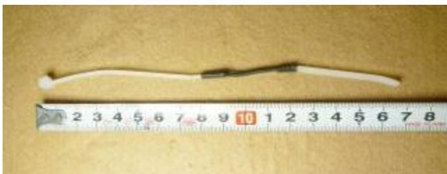
切断した結束バンドは約 145mmなので、ほぼ真ん中で切断し、それぞれの端にφ0.7mmの孔を開け、φ0.28mmのステンレス線の約 150mmを二つ折りにし、バンドの端の孔を通して1周させ縛ります。振った端末の尖りを保護するため、
