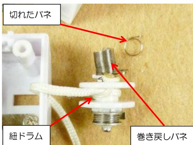
リード線付き端子とネジを外すと切れたバネがあり、紐ドラムと巻き戻しバネを外すと、巻き戻しの構造が分かります。
