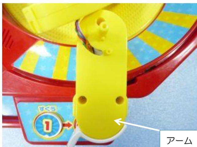
ギアと円板とバネをアーム支点に戻し、ネジ（タッピング 2.4×8）2本とネジ（タッピング 2.4×5）1本でブームカバーを留めます。
