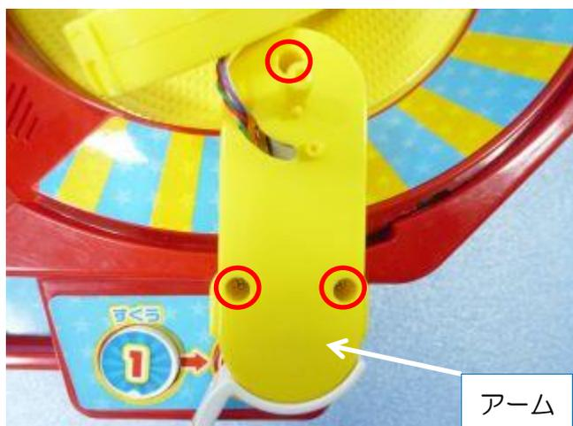
さらにアームを外し○印のネジ (タッピング 2.6×8) 3本を外します。
