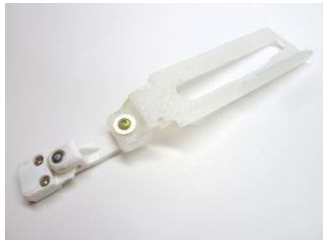
E系新幹線 こまちのラックギア付き連結器摺動板
