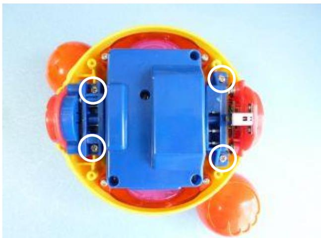
回転箱をボールケースに入れ、○印のネジ (タッピング 3X10) 4本で留めます。
