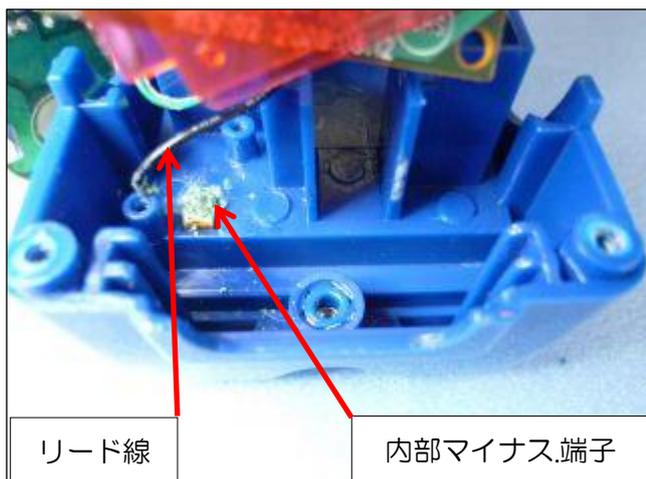
やっと見つかりました。内部マイナス端子が電解液漏れで錆び、リード線も錆びて断線しています。
