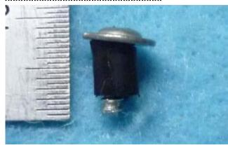
残った軸に  $\phi$ 2mmの穴を開け、ネジ(座付きタッピング 2.3X10)に  $\phi$ 3 収縮チューブ 5.5mm を通し、ネジの先端に PPX を塗布し接着します。
