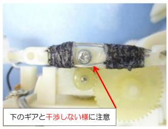
(例3) φ09mmステンレス線で形を作り、φ028mmステンレス線を巻き付けあるいは縫合し、 接着剤のPPXで固定
