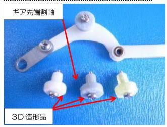
残った軸に  $\phi$  1.8mmの穴を開け、3D 造形品 (スペーサー)にネジ(M2X1O)を通し、ネジの 先端に PPX を塗布し接着します。
