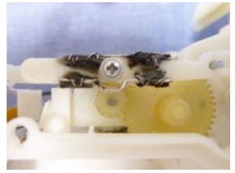
(例2)  $\phi$ 0.9mmステンレス線を添えミシン糸を巻き付け、補強材として重曹をまぶし瞬間接着剤で固定
