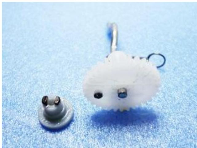
○突起の黒マジック印は、3D 追加先端部品を位置決めする基準印。
