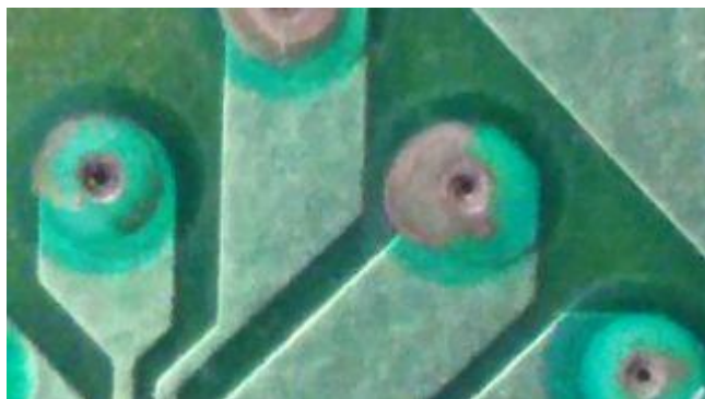
腐食したスルーホールの錆
