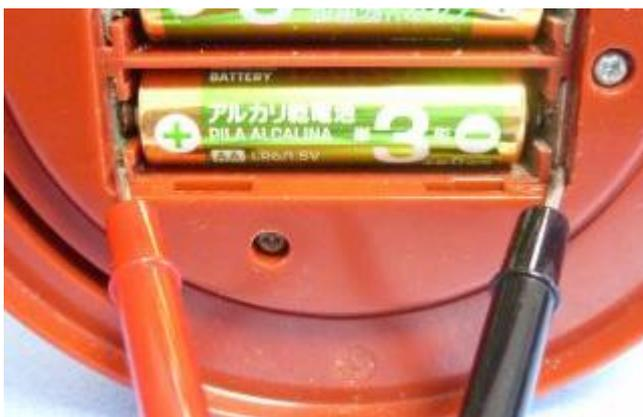
電池金具と電池が接触しているかは、電池を入れた状態で電池金具（+）と電池金具（-）の間をテスターで電圧測定します。電池1個毎に約1.5Vあれば問題ありません。それ以下であればまだ錆などが残っていますのでさらに研磨をします。
