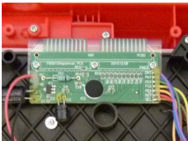
電極シートと基板接続部
