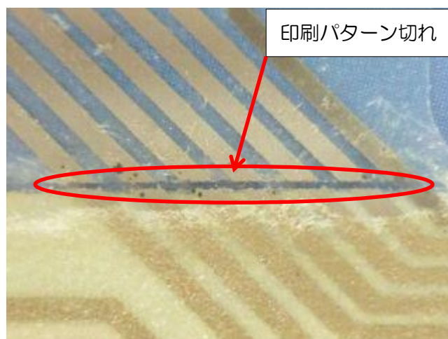
電極シート曲げ部のパターン切れ
