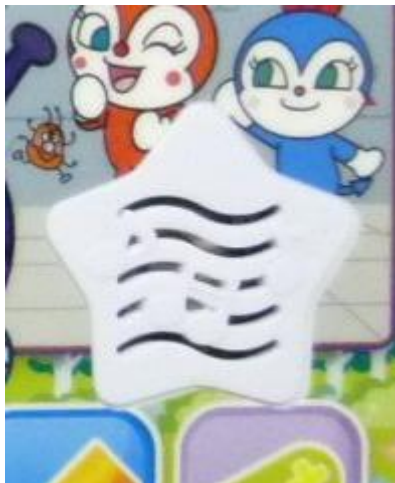
キーボード部のスピーカ用孔
