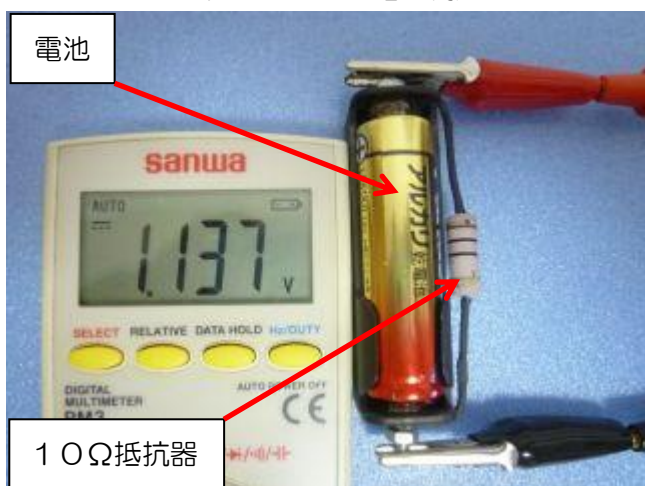
テスターでの電圧測定
