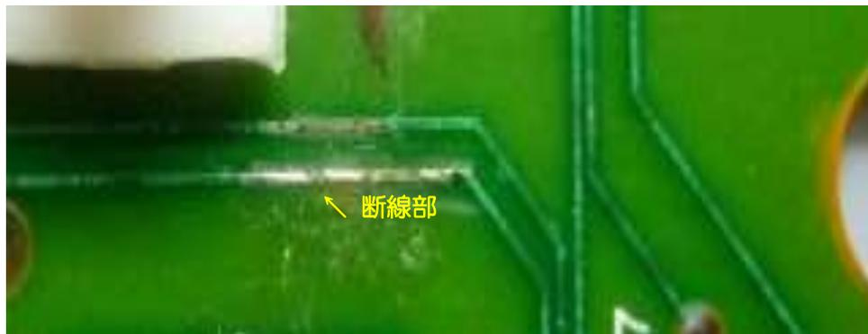
もし、銅箔パターンが細く、隣の銅箔パターンとの間隔が小さい場合は、極細ウレタン電線（小型リレーなどのコイル）を利用し、半田付けしても良いです。
