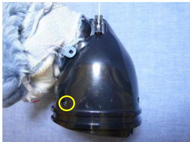
右耳の樹脂芯板が立っている時は隠れて見えませんが、降ろすと見える○印のネジ (タッピング 2.3X6) 1本も外します。
