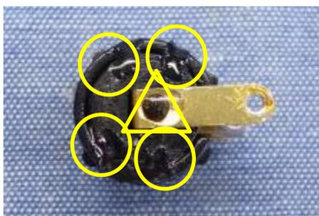
元に戻すにあたり、上面ふた部の外した○印の熱溶着跡4か所と、△印の1番端子留めを2液性エポキシ接着剤で固定します。
