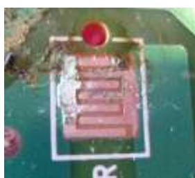
↑ （例）腐食した他の接点
