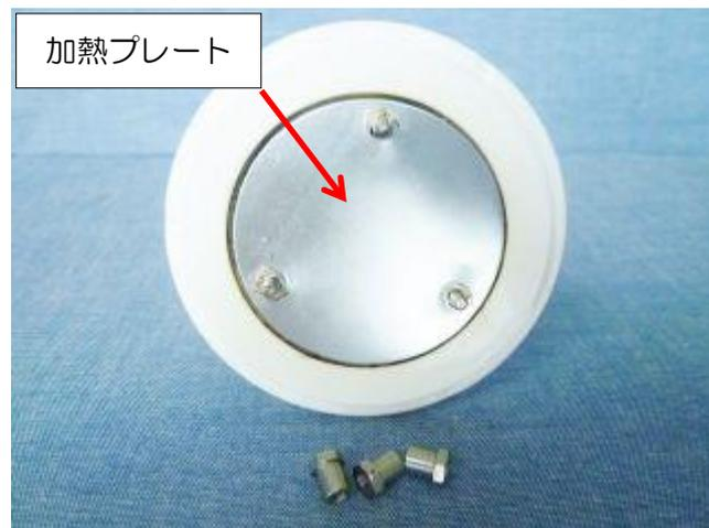
ヒータ線の両端の抵抗を測ると  $3.0\Omega$  でした。ヒータ線の近くにあめの汚れが残っていますが、構造的に触れることなく、ヒータ線の抵抗値に影響はありません。
