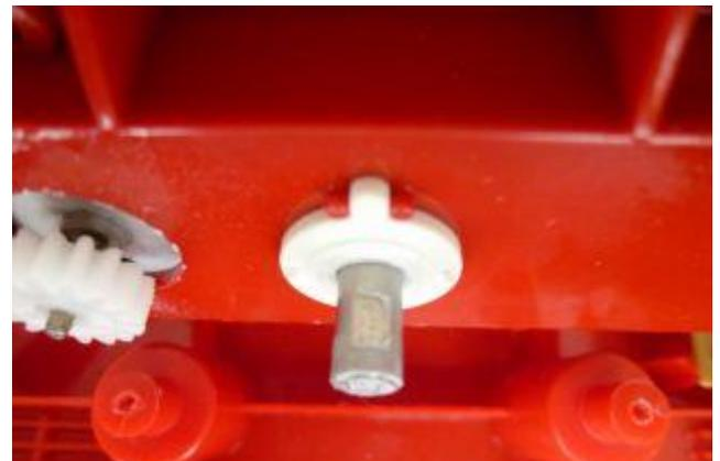
ヒータ部裏側を詳細に見るため、上へ引き抜きます。
