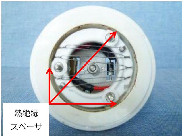
ヒータ部の上に、加熱プレート（内側に絶縁シート）を被せ、M3雌ネジ付き根元ナットで留めます。
