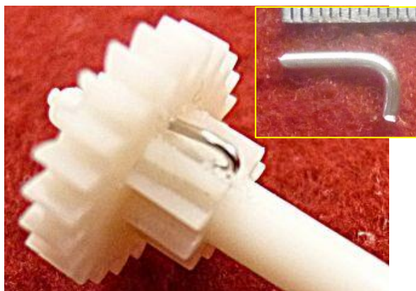
修理後 (φ0.9mmステンレス線+PPX)
