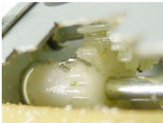
修理後（φ0.5mmステンレス線+PPX）
