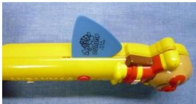
使い方は、隙間に差し込み係合を外します、開いた隙間をドライバーなどで開いた状態に保ち、少し離れた隙間を同じように、開きと保持を繰り返して、全周を開きます。
