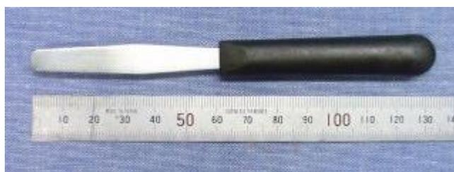
厚みが 0.7mm、ステンレス製なので剛性があります、幅が約 10mmあるので合成樹脂製の外装箱を傷つけることが少ないです。
