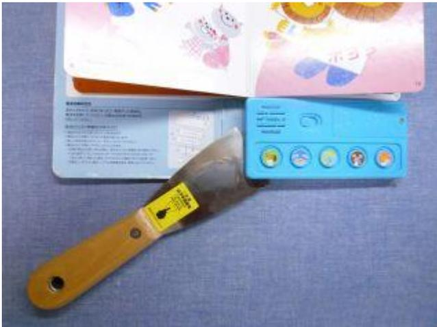
使い方は、音楽絵本の裏台紙をドライヤーで温めて、裏台紙とおもちゃの間の両面テープの接着力を弱め、金へらの厚みと幅広さを活かして、少しずつ剥がし台紙から分離します。
