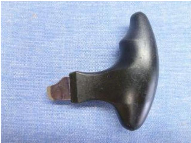
厚みが 1.2mm で、先端 2.5mm が厚み 0.2mm までテーパ状に薄くなっています。
