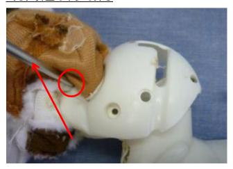
非常に分かり辛いですが、鼻の下の布からドライバーの先を差し入れ、手探りでビス孔を探り、ネジ(タッピング 2.5X6) 残り1本を外します。
