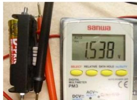
(c) 100均のアナログ式バッテリーチェッカー（2Ω抵抗負荷）で電池を測定します。
