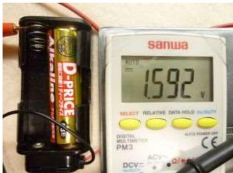
(b) デジタル式テスターで10Ω抵抗負荷での両端電圧を測定します。
