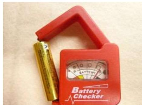
(d) 100均のアナログ式バッテリーチェッカー（2Ω抵抗負荷）で電池を測定し、同時にデジタル式テスターで両端電圧を測ります。
