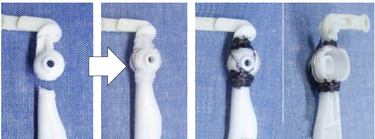
例4 修復前 ⇒ ステンレス線φ0.3+φ0.9+縫製糸+瞬間接着剤+重曹+瞬間接着剤 (目立つように黒マジック印)
