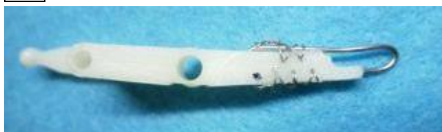
例1 ステンレス線φ0.3、φ0.9+瞬間接着剤
