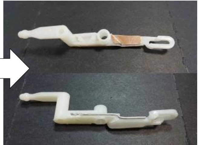
例6 修復前 ⇒ ステンレス線φ0.3、φ0.9+ t 0.3 黄銅板+瞬間接着剤 (by Hashi. Dr.)
