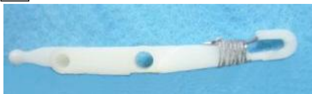
例2 ステンレス線φ0.3、φ0.9+瞬間接着剤
