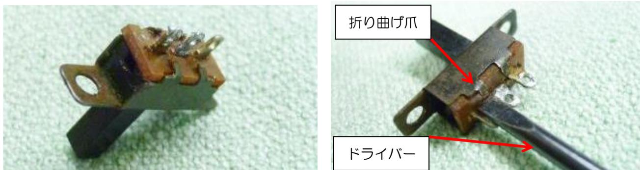
全ての折り曲げ爪を起こし、端子部を持ち上げます。分解すると、左から金属ケース、つまみ、バネ、接点バー、端子部になります。
