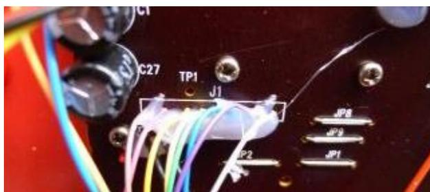
ケーブル根元保護用のホットメルト（グルー）を外す時、リード線を切る恐れがありますので、ホットメルトを外す前にリード線の色と配置を確認し記録します。
