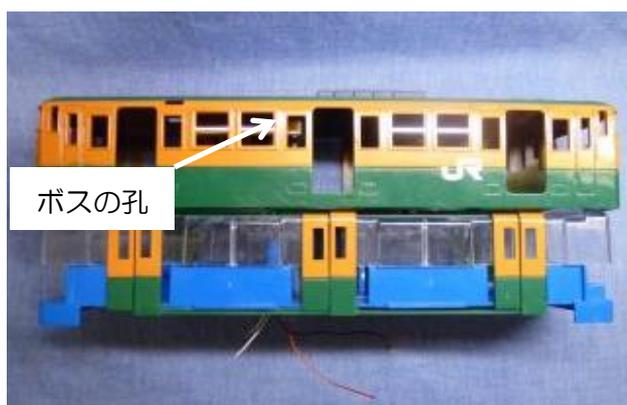
車体の外装と内装（ガラスとドア付き）を平行に置き、車体の外装と内装が前後上下ずれないように密着して被せ、外す時と同じようにこの前側と後側で交互に、少しずつ内装を持ち上げはめ込みます。
