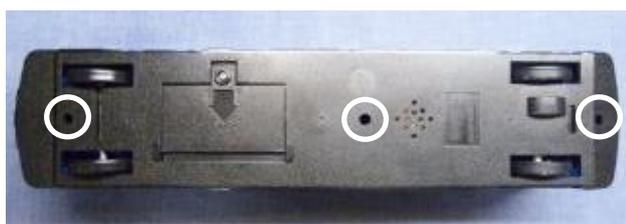
合体した車体の外装と内装に車台を被せ、ネジ（タッピング2.6×10）3本で留めます。
