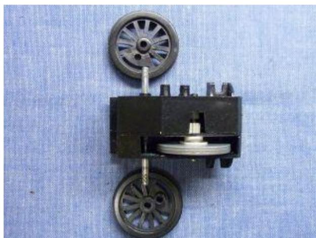
駆動車輪の軸孔が割れて径が大きくなっています。
