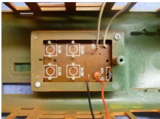
車体の外装と内装（ガラスとドア付き）を合体時、リード線を挟み込まないように、内装のボスの孔にリード線を通します。
