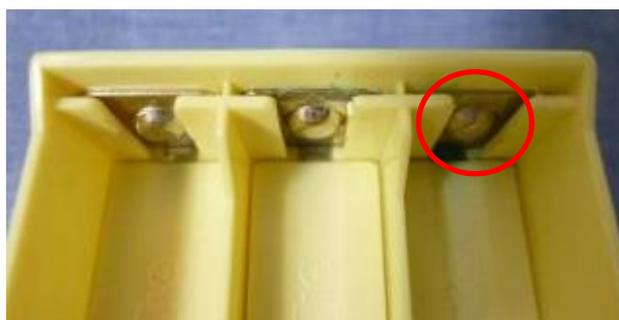
電解液で腐食した電池金具の錆を、リユーターで削り落とし、電解液の粉や錆の粉を歯ブラシや爪楊枝などで取り除きます。
