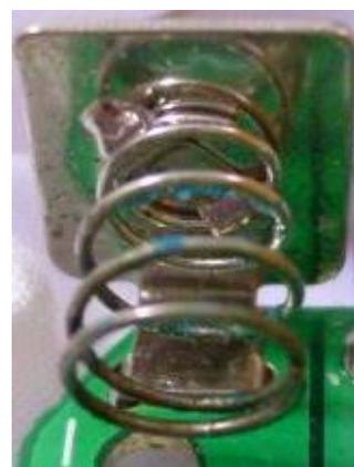
本体内で見つけた2個の電池金具の錆を、リューターで削り落とし、電解液の粉や錆の粉を歯ブラシや爪楊枝などで取り除きます。
