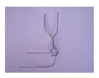
輪部は脚の支点のボス部を囲み、下のφO.5mm ステンレス線は支点の板部を挟み込みます。
