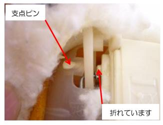
後脚近くの電池収納部周囲の生地を剥がす時に、後脚に力が加わったためか、両側の後脚の支点のピンが折れてしまいました。(2次故障)
