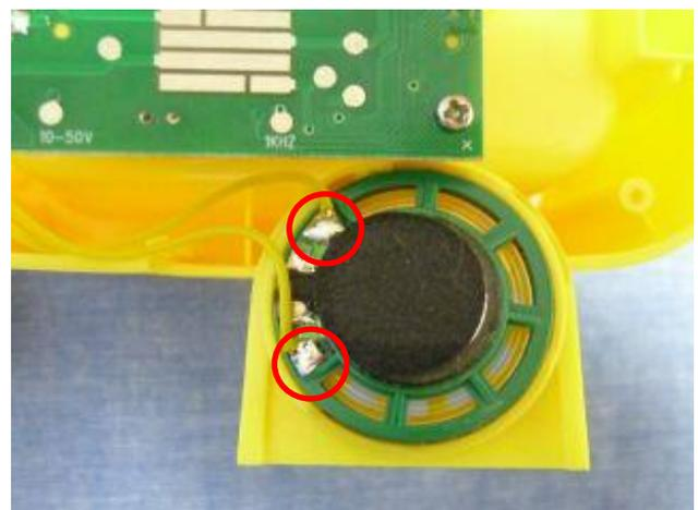
後部のスピーカは、取付板ごと上にスライドすれば外れ、スピーカチェッカで点検できます。
