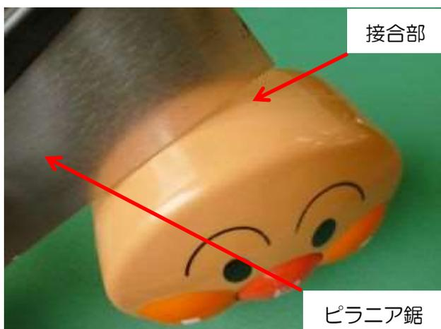
まずケースをピラニア鋸（刃厚み0.2mm）で切ります。他の鋸でも良いですが、できるだけ刃の厚みが薄い方が綺麗に切断できます。
