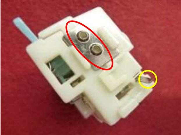
「+」電池端子（赤丸）と「-」電池端子（黄丸）に1.5Vを印加して、回転を確認します。
