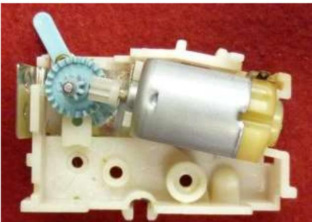
スイッチをON側にし、シャフトの長い方を軸受けに差し込みます。
