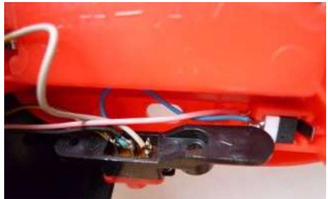
電源スイッチ端子3か所や、リセット用マイクロスイッチの端子の半田の錆やリード線の外れを点検します。
