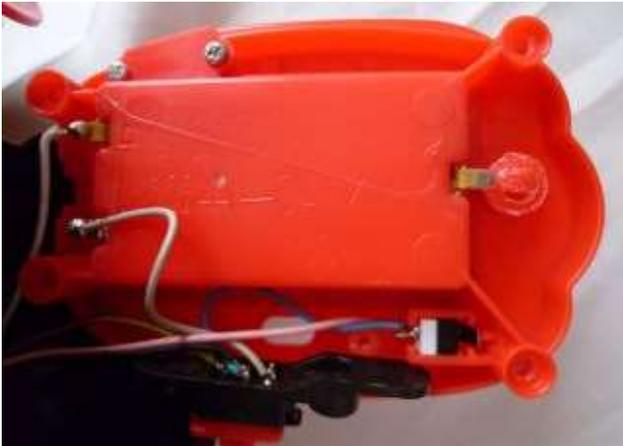
4本のビス（タッピング 3×9.5）を4本外し、電池端子の錆やリード線の半田外れなどを点検します。（以降のビスはすべてタッピングビス）
