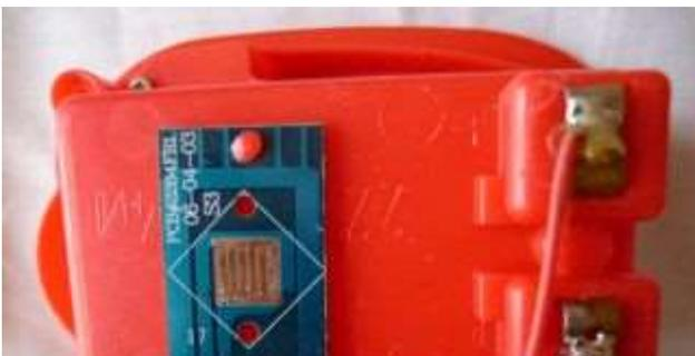
4本のビスを外し、電池端子の錆やリード線の半田外れ、脚スイッチ基板のリード線の半田外れ、足スイッチ基板のスイッチ部の汚れを点検します。
