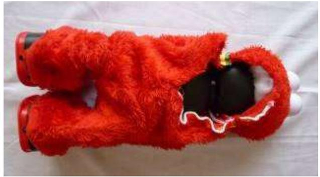
むいぐるみの頭部を外し、黒い本体ケース下側の締め付けビル2本が外せる様になるまで、むいぐるみを剥がします。
